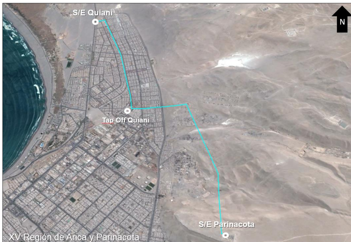
Figura 9.23: Área del proyecto tendido segundo circuito Línea 66 kV Parinacota – Quiani.
