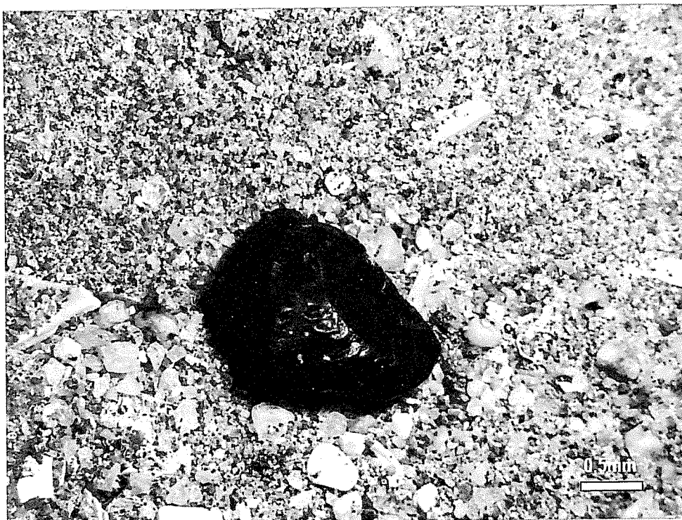
Figura A-11. Fotografía con lupa binocular en aumento 0,67x de partícula de carbón en la muestra QV-12.
