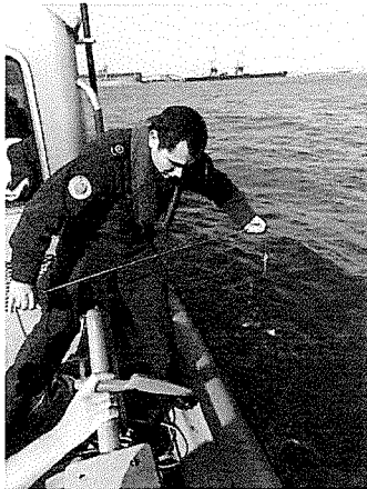
Figura 2. Muestreo manual de sedimento marino con draga a bordo de la lancha LPM "Arcángel" (8 de agosto de 2019).
