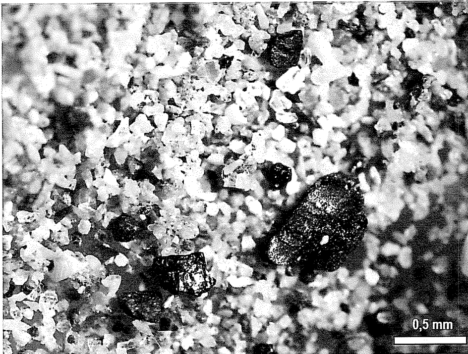
Figura A-1. Fotografía con lupa binocular en aumento 3x de partículas de carbón en la muestra QV-01-A.
