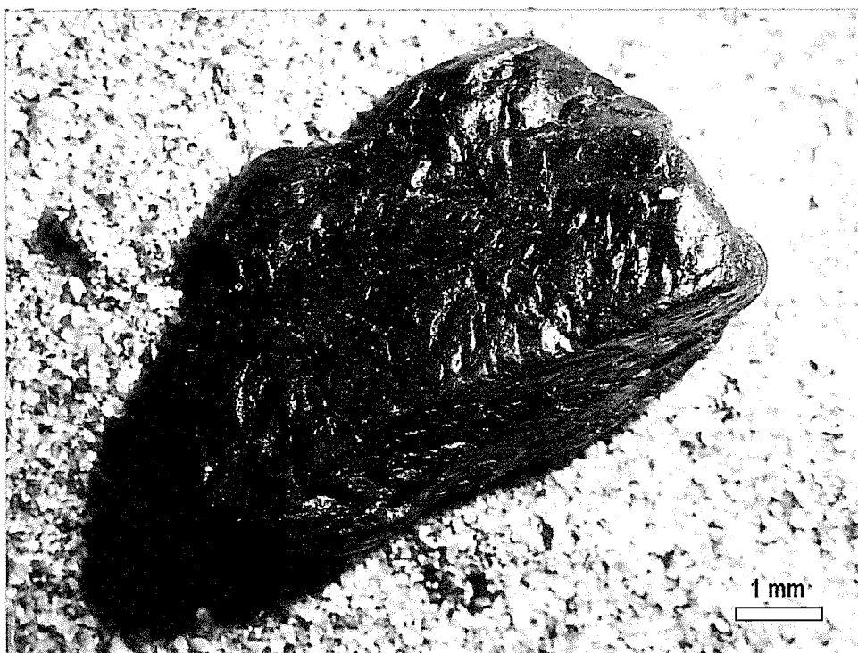
Figura A-16. Fotografía con lupa binocular en aumento 0,67x de partícula de carbón en la muestra QV-20.
